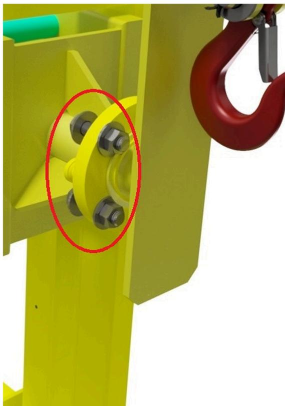
*Figura 08 – Conjunto de fixadores do kit de acoplamento*
