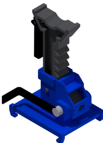
Figura 12 – Região de Apoio e Dentes da Haste (Cremalheira)
