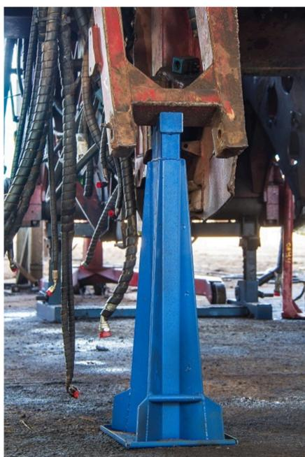
Figura 04 – Exemplo de Utilização dos Cavaletes – CNF 80
