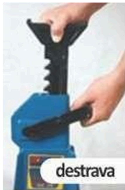
Figura 06 – Exemplo de Movimentação e Destramento da Haste
