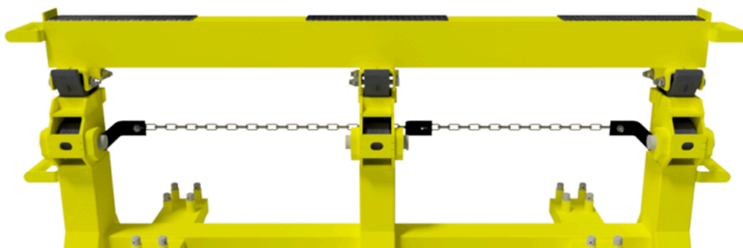
Figura 03 – Exemplo de nivelamento da travessa
