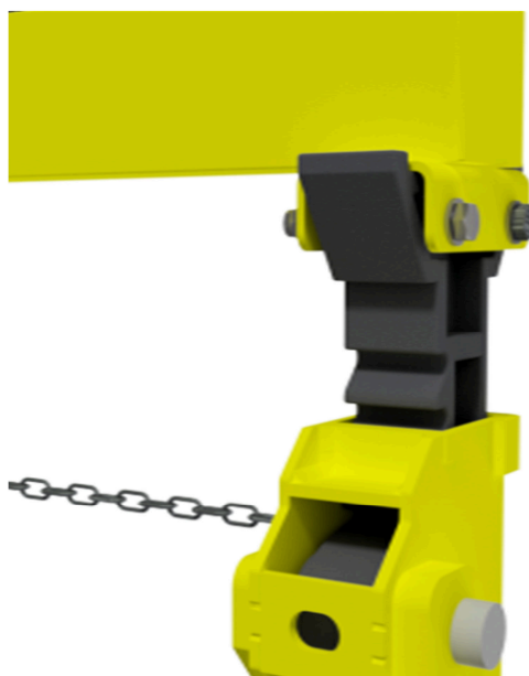
Figura 06 – Região de Apoio e Dentes da Haste (Cremalheira)
